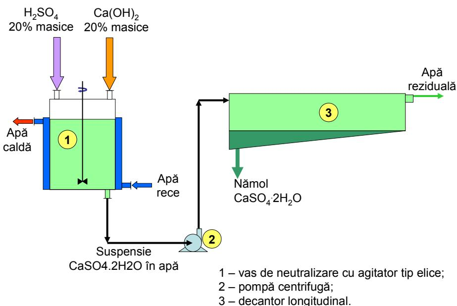
În neutralizatorul (1) se introduc în flux continuu soluția reziduală de H<sub>2</sub>SO<sub>4</sub> și soluția de Ca(OH)<sub>2</sub> (în raport stoichiometric). Neutralizarea acidului este totală, și se desfășoară conform ecuației caracteristice globale:
