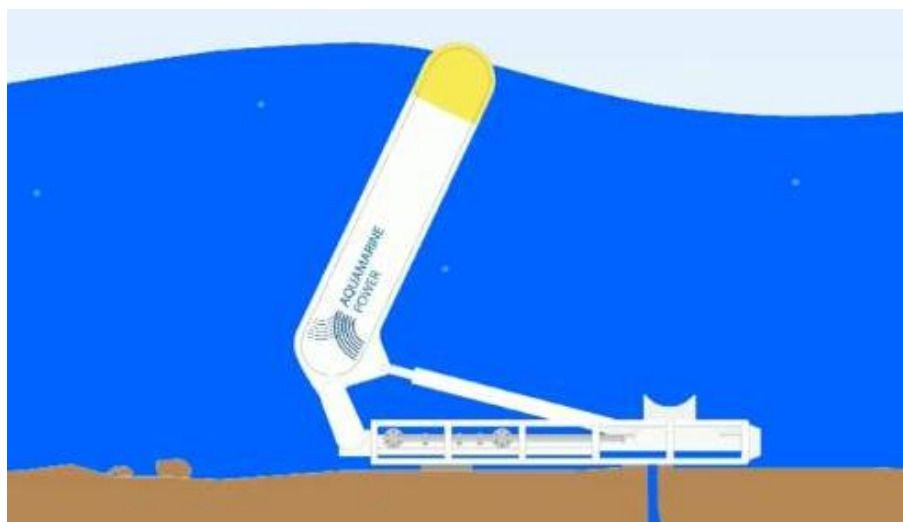
Fig. 5.8 – Principiul de funcționare al convertoarelor oscilante imersate 49
