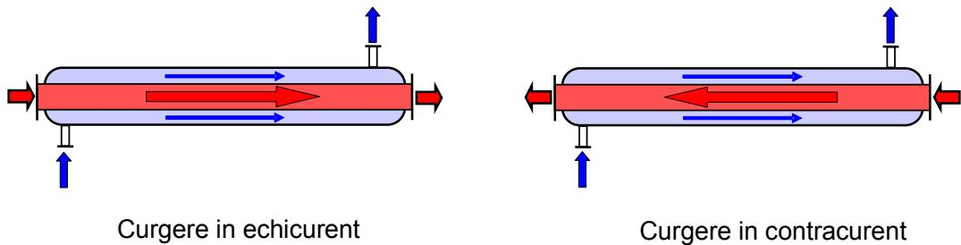
Teava interioară are diametrul interior ( $d_i$ ) de 50 mm și diametrul exterior ( $d_e$ ) de 54 mm. Teava exteroară are diametrul interior ( $D_i$ ) de 100 mm și diametrul exterior ( $D_e$ ) de 105 mm. Lungimea totală a schimbătorului este de 1,25 m. Prin țeava interioară curge un fluid  $F_1$  care se încălzește de la  $T_{1i}$  la  $T_{1e}$ , iar printre cele două țevi circulă un fluid  $F_2$  care se răcește de la  $T_{2i}$  la  $T_{2e}$ .
