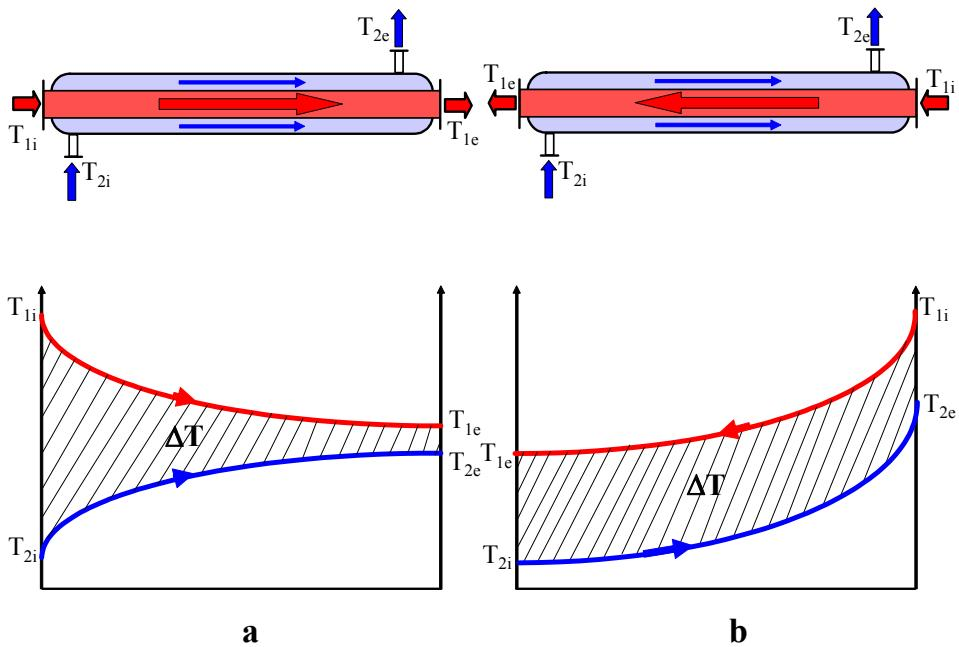
De regulă,  $\Delta T_m$  se calculează ca medie logaritmică între diferențele de temperatură dintre cele 2 fluide la extremitățile schimbătorului:
