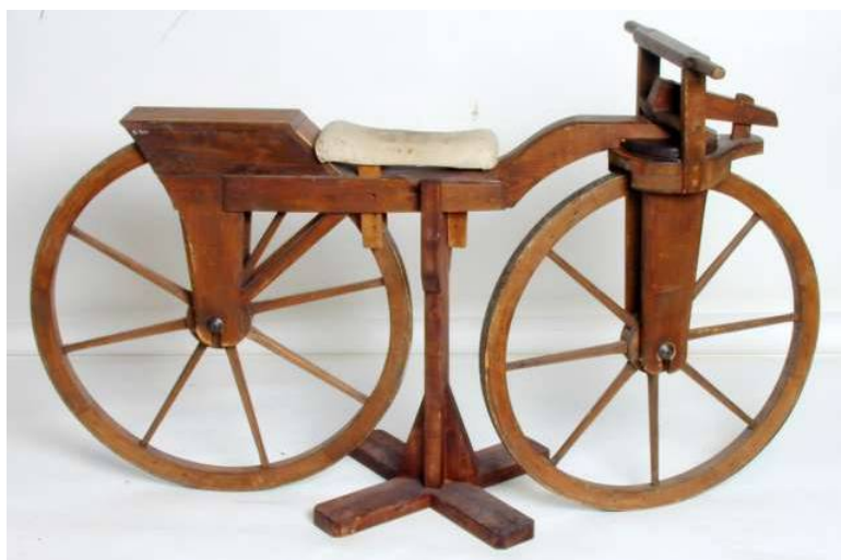
Fig.22. Mașina de mers inventată de baronul von Drais (după http:// www.tekniskmuseum.no/.../sykler/forside.htm )
