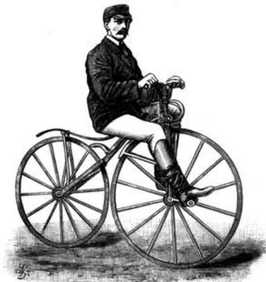
Fig.21. Velociped cu pedale fixate direct pe roata din față (după http://www.know-library.net/images/9/91/Velociped.jpeg )
